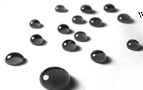
Abb. 1 Wassertropfen perlen auf Nanopapier einfach ab.
