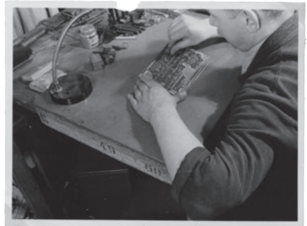
Abb. 6. Reissen und manuelle Korrektur der Druckplatten. Foto: NARA
